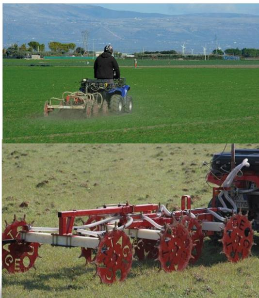
**Figura 26 Sistema di acquisizione dei valori geoelettrici (GEOCARTA)**
