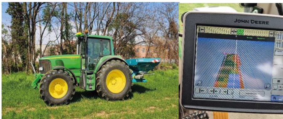
Figura 34 Spandiconcime centrifugo dotato di sensori per l'AdP e trattore ISOBUS con posizionamento GNSS (sx). Mappa di distribuzione a rateo variabile del concime (dx).
