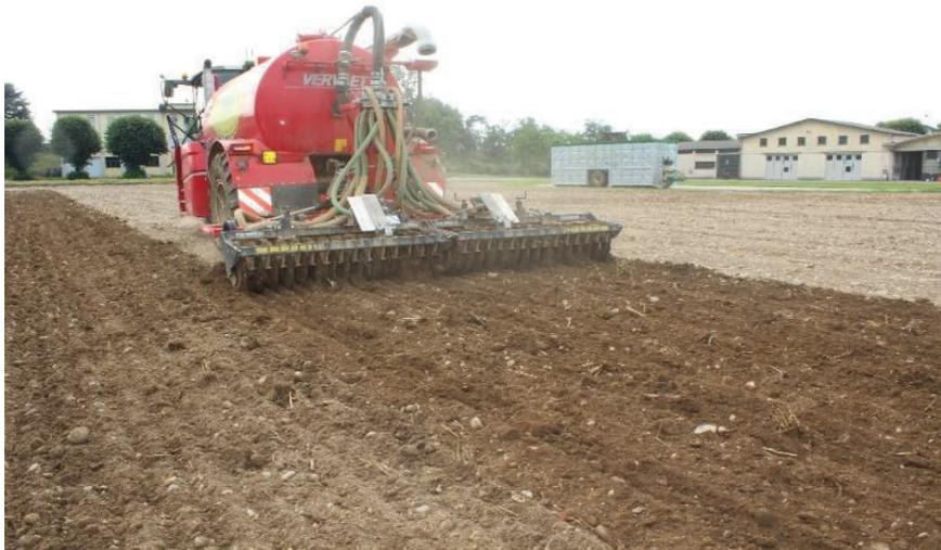
**Figura 36 Spandiliquame semovente di precisione con guida automatica, controllo della dose distribuita e sensore NIR per la determinazione del contenuto in azoto**
