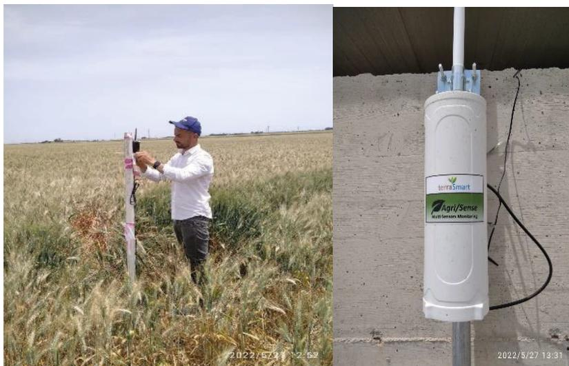
**Figura 29** Installazione di una sonda (sx) e ricevitore-trasmittitore dati (dx).
