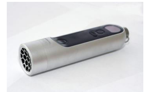
Fluorimetro portatile per determinare la maturità fenolica
