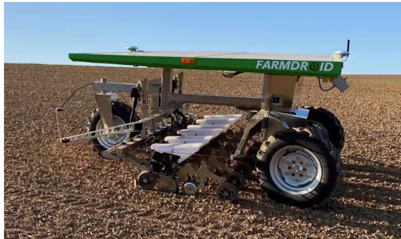
Farmdroid, robot per la semina e il controllo meccanico delle malerbe
