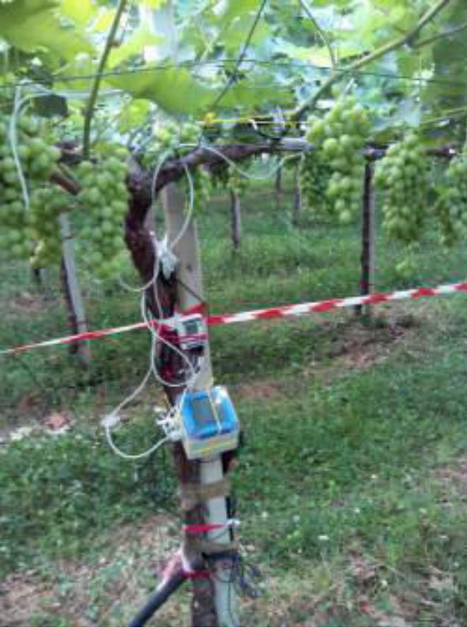
La stazione meteorologica è un componente fondamentale per l'utilizzo dei sistemi di supporto alle decisioni (DSS). Essa permette di rilevare il microclima che circonda la pianta ed in generale del vigneto aziendale.
