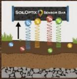
Lo scanner SoilOptix® misura gli isotopi emessi naturalmente cesio, uranio, potassio e torio. Un sensore montato sul veicolo di raccolta dati, a 60 cm dal suolo, rileva la radiazione gamma, misurando le proprietà geologiche naturali
