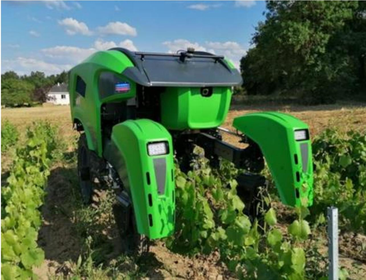
Il robot agricolo Trektor è in grado di lavorare autonomamente su vigneti a filari stretti e larghi, in orticoltura e in arboricoltura grazie alla possibilità di variare sia la carreggiata delle ruote (motorizzata con regolazione a un passo di 530 mm), sia la larghezza e l'altezza del veicolo (motorizzata con regolazione a un passo di 400 mm).
