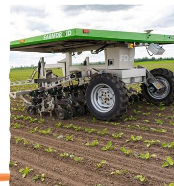
Le seminatrici di precisione, a distribuzione essenzialmente pneumatica, sono adatte per basse densità di semina, perché depositano un seme per volta mentre quelle a distribuzione meccanica sono più adatte per le alte densità.
