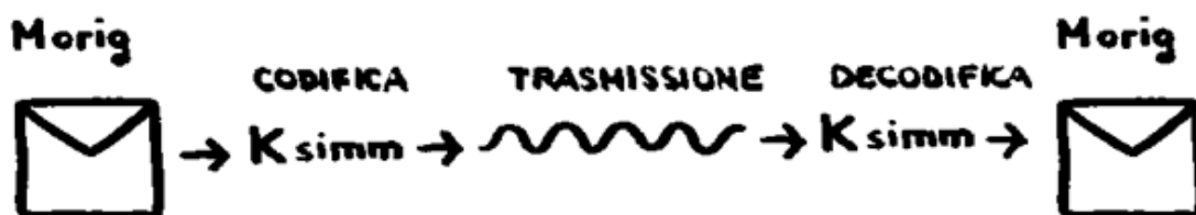
Figura 20 | Schema esemplificativo di un sistema simmetrico
