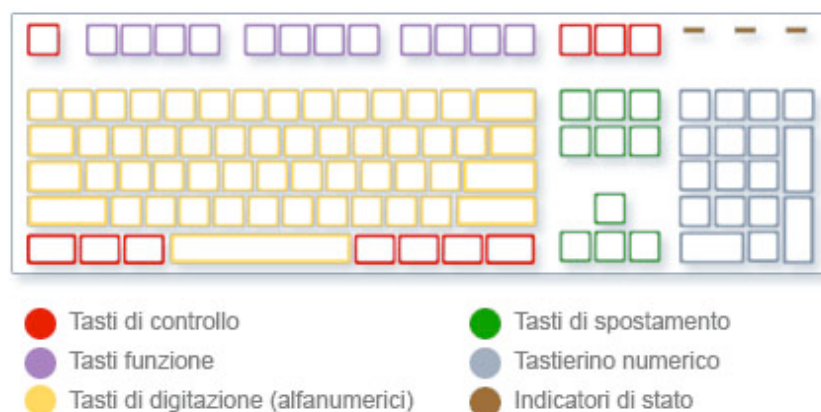
Figura 20 | Lo schema generale di una tastiera
