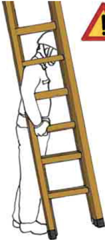
Fig. 6 - Modalità errata di trasporto della scala a spalla
